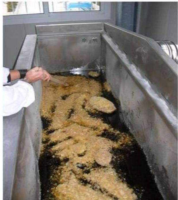
Figura 3. Preparazione del bagno di colofonia
