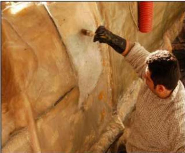
**Figura 10.** Applicazione degli strati di vetroresina
