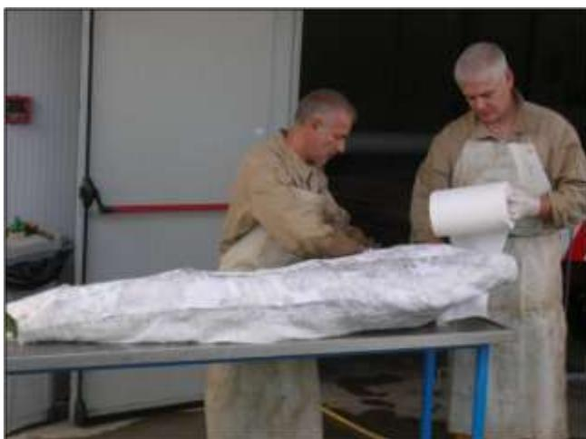
**Figura 21.** Rivestimento di un elemento ligneo con carta
