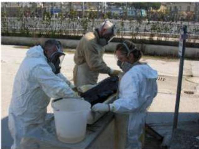
Figura 4. Prima pulitura di reperto ligneo dopo il bagno di trattamento
