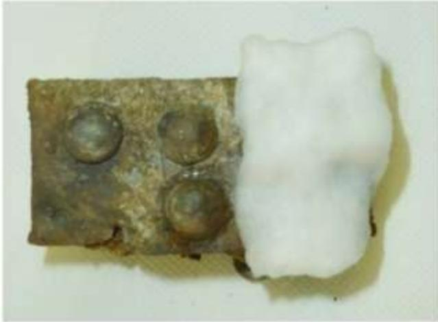
**Figura 14.** Prove di pulitura per imbibizione con solventi, su un reperto laminato in argento
