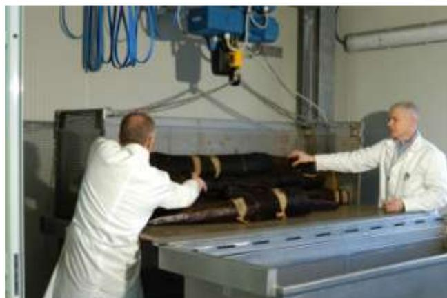
**Figura 2.** Trasferimento di tronchi lignei da una vasca all'altra nel corso del trattamento con la colofonia.
